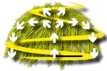
Απεικονίζεται η κυκλική κίνηση των προϊόντων στην δεξαμενή ανάμιξης με σκοπό την γρήγορη και αποτελεσματική κοπή και μίξη όλων των συστατικών.
