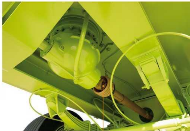
Υπερμέγεθης πλανητικός μειωτήρας(βασικός εξοπλισμός) Standard gearboxes for heavy duty
