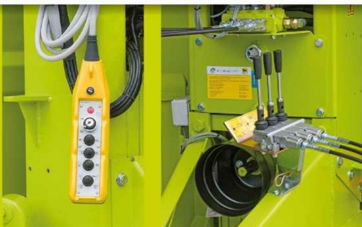
Δύο είδη ελέγχου : ηλεκτρικό χειριστήριο απομακρυσμένου ελέγχου(αριστερά) και χειριστήριο απομακρυσμένου ελέγχου με μηχανικά καλώδια(δεξιά)
